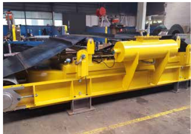
Andrin se distingue par sa capacité à produire de grosses unités : à gauche un électroaimant de 24 tonnes et 70kW de puissance, à droite un overband électromagnétique de 24 tonnes et 87kW de puissance, l'un des plus gros au monde (6 m de long, 2 m de large, distance d'attraction jusqu'à 1m).
